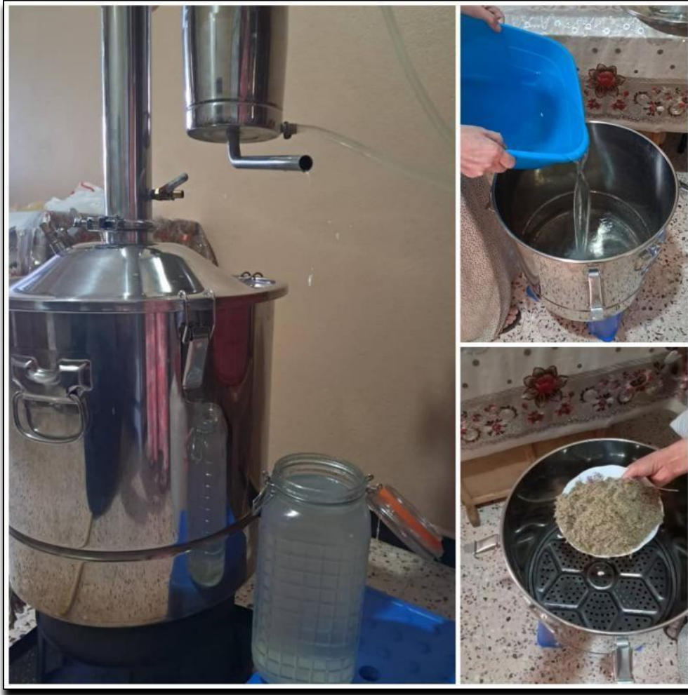
Fig.22: Les étapes d'hydrodistillation (Photos originale, 2025)
